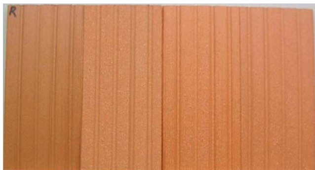
Foto 3. Van links naar rechts, referentie A, monster 1A, 4A en 5A na 1008 uur snelverwerking.
