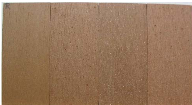
Foto 4. Van links naar rechts, referentie B, monster 3B, 4B en 5B na 1008 uur snelverwerking.
